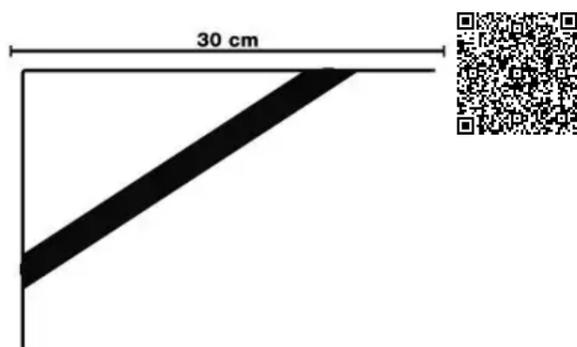
**Materiales** Acero Carbono + Pintura Epoxica y Electroestática
